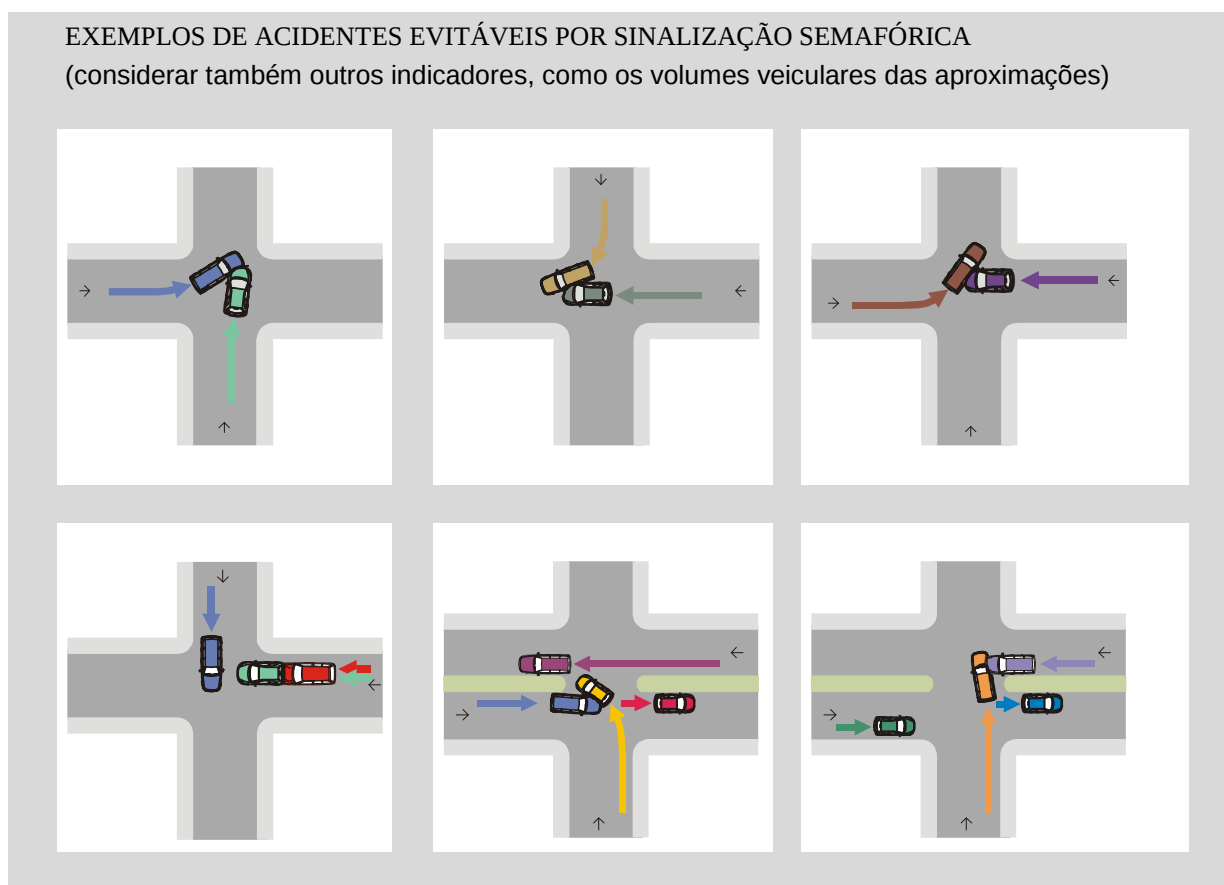
Figura 4.12: Exemplos de acidentes evitáveis por sinalização semafórica
