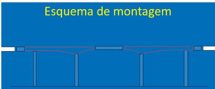
**FIG. 31 – ESQUEMA SIMPLIFICADO DE MONTAGEM DOS VÃOS PRINCIPAIS**
