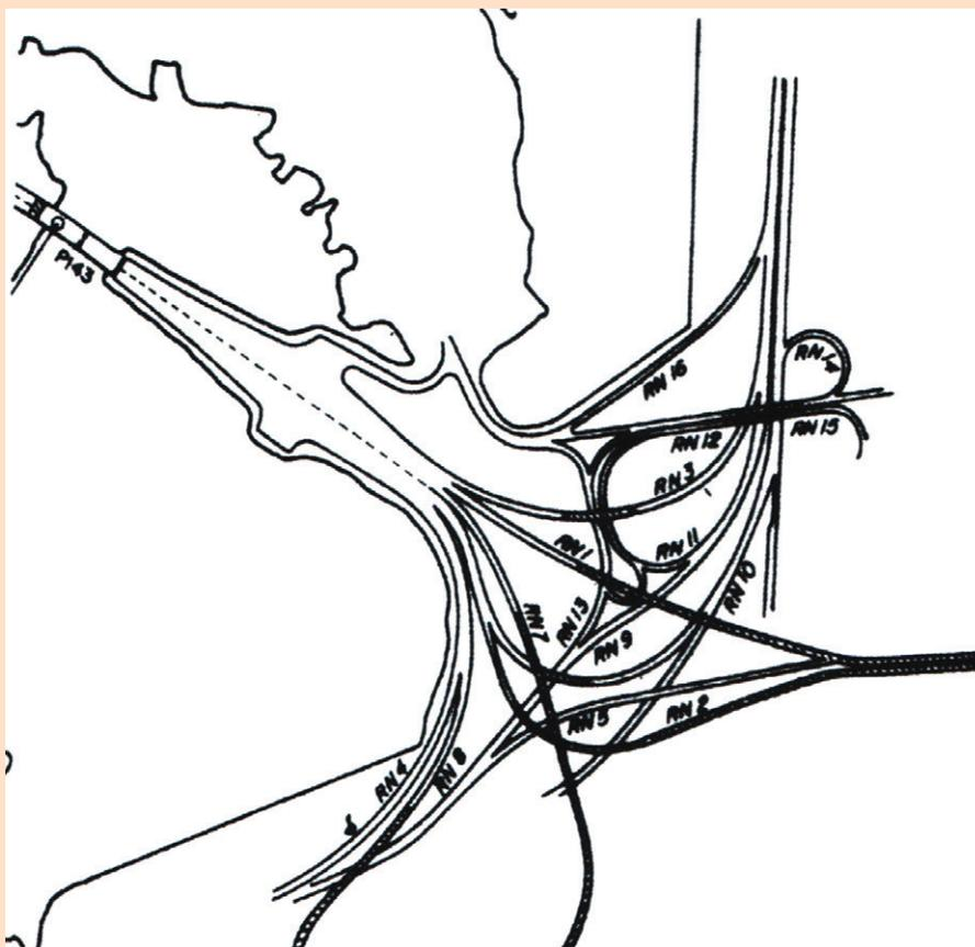
FIG. 2 – ESQUEMA DOS DOIS ÚLTIMOS TRECHOS DA PONTE RIO-NITERÓI MOSTRANDO A COMPLEXIDADE DA ESTRUTURA DO ACESSO A NITERÓI (REPRODUZIDO DE [6])
