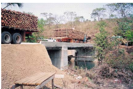
Figura A9 – Prova de carga no vão maior
