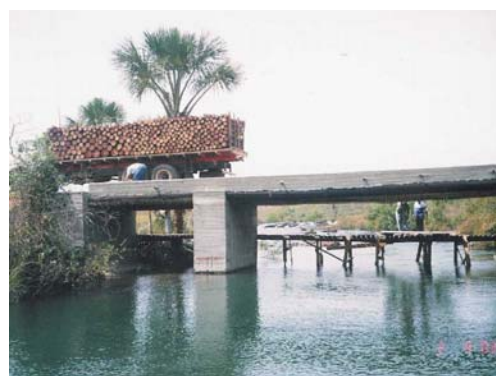
Figura A10 – Prova de carga no vão menor
