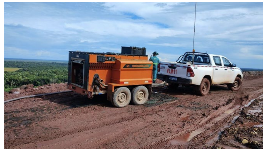
Foto 4: Conjunto de caminhonete e equipamento de hidrossemeadura modelo reboque com capacidade de 2000L.
