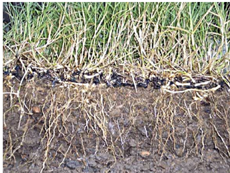
Foto 14: Detalhe do entrelaçamento das raízes da vegetação com a geomanta.
