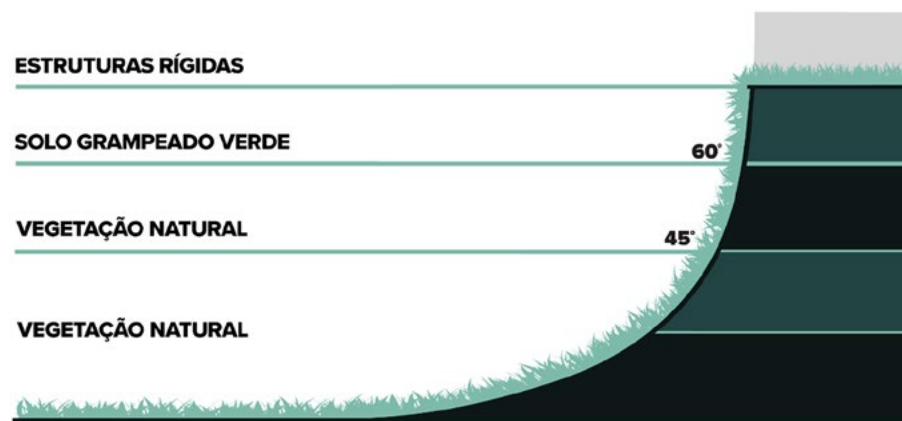
Figura 1: Ilustração dos tipos de áreas com diferentes inclinações e onde somente a hidrossemeadura é usada (Vegetação Natural) e onde a hidrossemeadura pode ser usada juntamente com geomantas (Solo Verde Grampeado).
